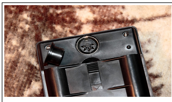
Rys. 3. Gniazdo sondy zewnętrznej ze zdjętą zaślepką.
